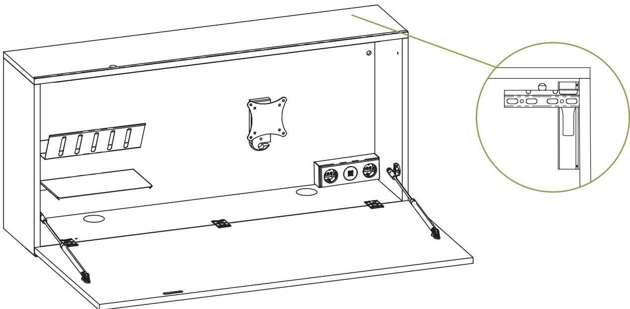
Mit Beschlag für eine einfache Montage und Ausrichtung an der Wand – Schrankaufhänger mit Tiefenverstellung und Abhebesicherung.
